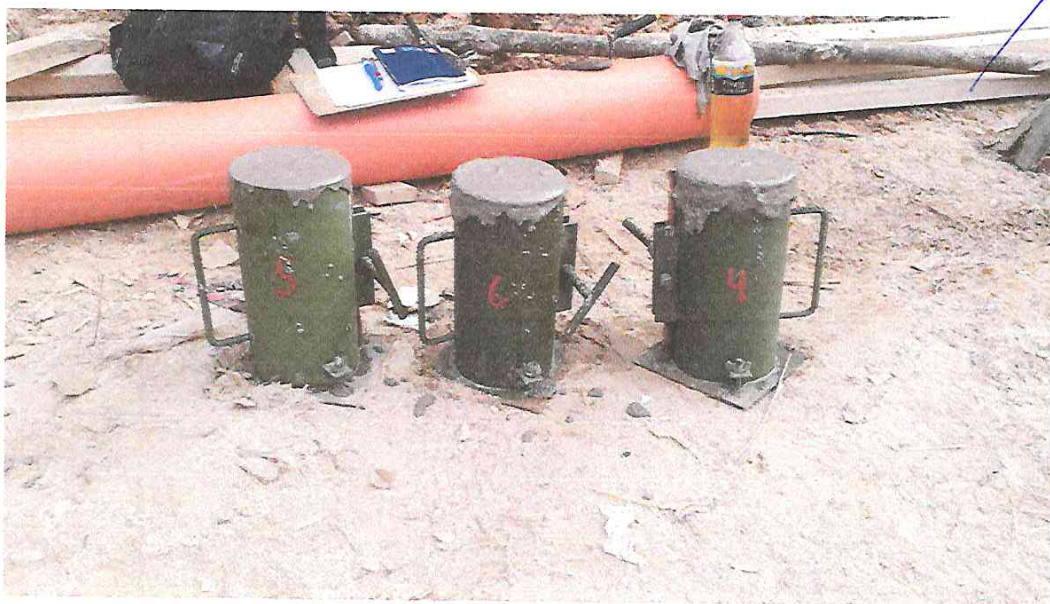
FOTOGRAFÍA 22: COLOCACION DE MORTERO EN LAS PROBETAS PARA SU CONTROL Y ROTURA EN LOS TIEMPOS DETERMINADOS.
